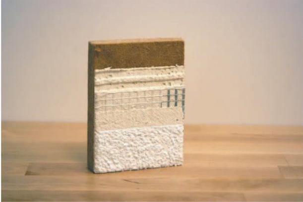
Sistema de aislamiento exterior a base de fibra de madera y revestimiento mineral.
