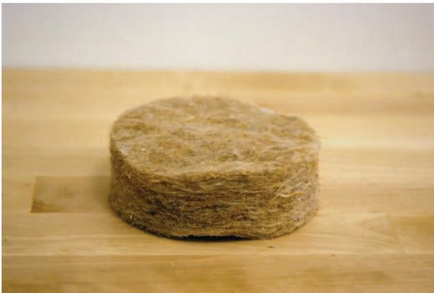
Redondeles de aislamiento de cáñamo para tapar los huecos de las fijaciones del aislamiento al soporte.
