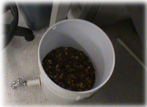
7) 21 cm de arena gruesa + geotextil protector +ramal
