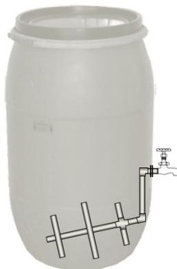
**Imagen 5. Sistema de drenaje del filtro<sup>3</sup>**
