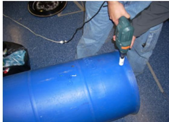
**Imagen 7. Perforación orificio de salida**
