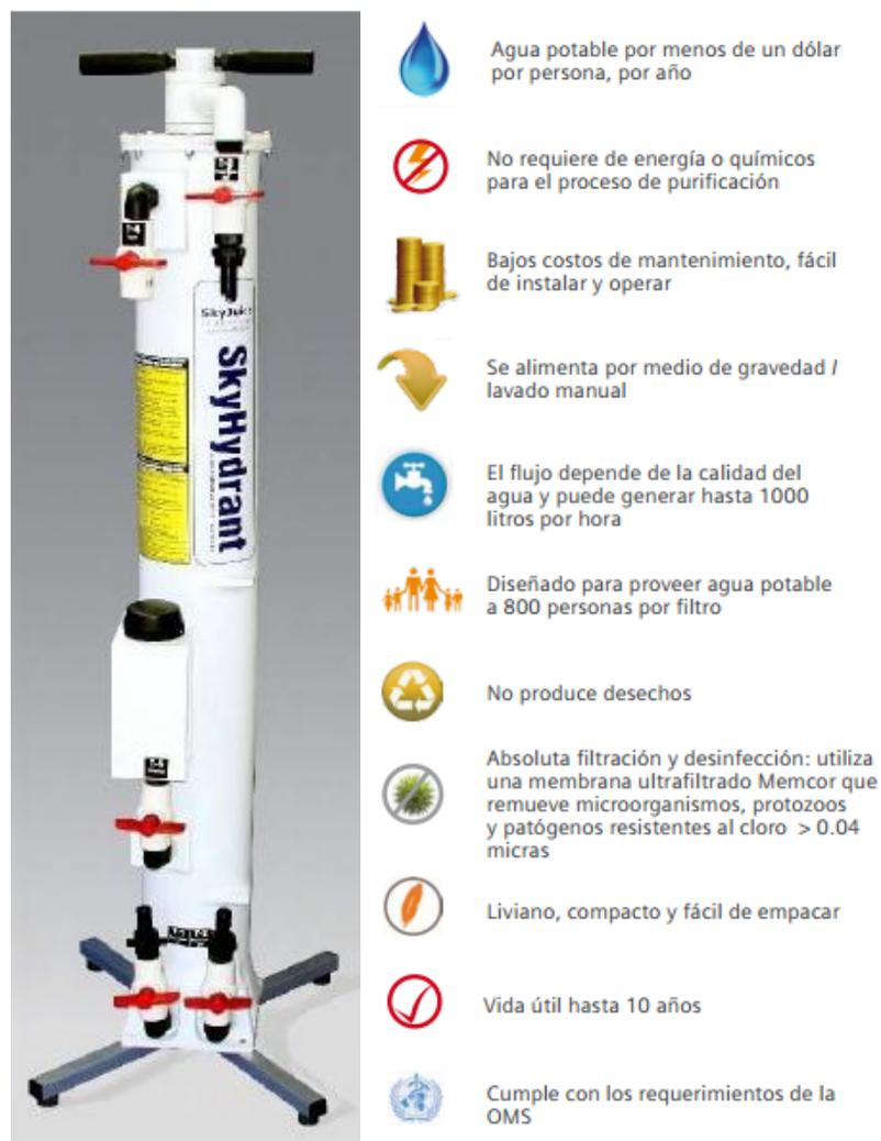
Imagen 2. Filtro SkyHydrant (Fundación Siemens, 2012)
